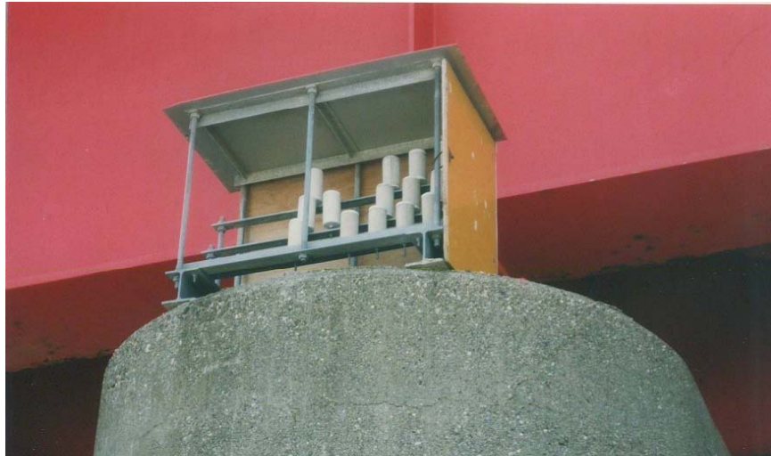
モルタル供試体 W/C=50% (早強セメント) ↓ 2ヶ月～2年暴露
